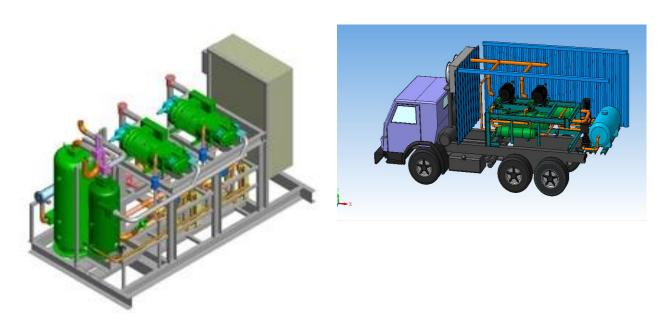
Рисунок 4 – Внешний вид холодильного агрегата
