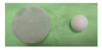
Рисунок 3 — Герметичные ёмкости, заполненные эвтектическим раствором различного диаметра 75 и 40 мм
