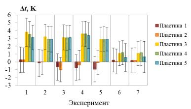
Рисунок 3 — Разница между температурой воздуха и температурой излучающей поверхности для каждой серии опытов
