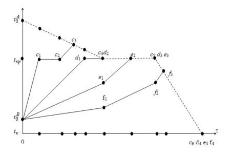
Рисунок 2 — Модель кинетики замораживания гетерогенной неизотермической системы:  $t_{\kappa p}$  — криоскопическая температура системы;  $t_0^A$ ,  $t_0^B$  — начальные температуры тел A и B;  $t_{\kappa}$  — конечная температура системы
