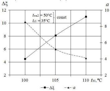
Рисунок 2 — График зависимости зоны дегазации и кратности циркуляции от температуры греющего источника
