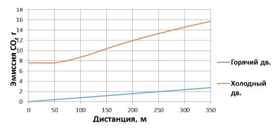
Рисунок 2 – График зависимости эмиссии CO при движении одного автомобиля с разогретым и холодным двигателем
