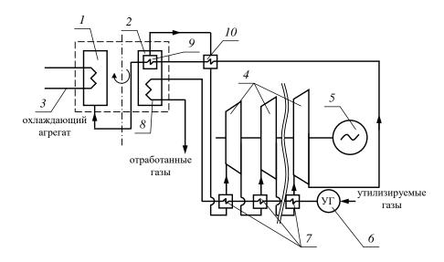
Рисунок 2 — Энергоустановка на базе ТСК: 1, 2 — генераторы-сорберы ТСК; 3 — система охлаждения ТСК; 4 — турбина; 5 — электрогенератор; 6 — система подачи утилизируемых газов; 7 — теплообменник; 8 — система нагрева ТСК; 9, 10 — регенераторы теплоты
