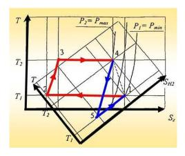
Рисунок 1 – Условное изображение процессов в термосорбционном компрессоре
