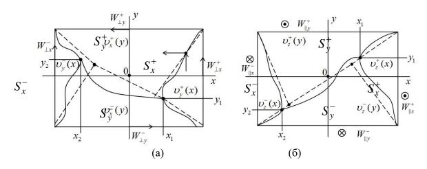
Рисунок — Розбивка и линеаризация прямоугольного канала: а — для поперечного течения, б — для продольного течения
