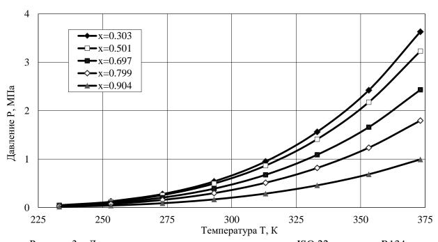
Рисунок 3 – Давления кипения смеси смазочного масла ISO 22 и хладона R134a
