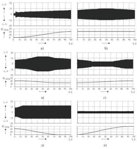
Рисунок 4 – Осциллограммы мгновенных значений тока двигателя и положения заслонки
