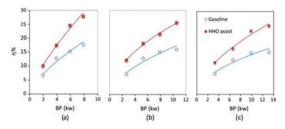
Рисунок 3 - Общее улучшение тепловой эффективности с ННО над чистым бензиновым топливом при разных скоростях двигателя:
