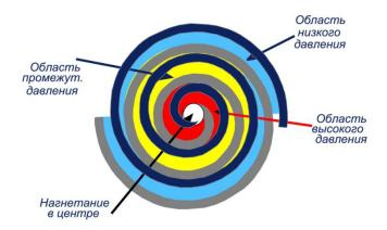
Рисунок 1 – Принцип действия спирального компрессора
