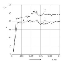
Рисунок 6 — Нагрузочные диаграммы I = f(t) двигателя дробилки при ручном (1) и автоматическом (2) регулировании производительности
