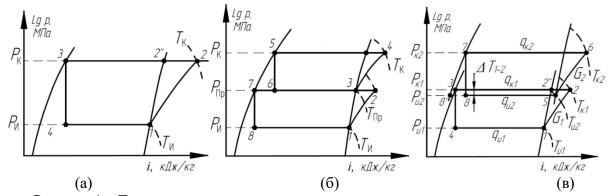
Рисунок 1 — Термодинамические циклы холодильных машин: a-c одноступенчатым сжатием, b-c двухступенчатым сжатием и полным промежуточным охлаждением, b-kаскадный
