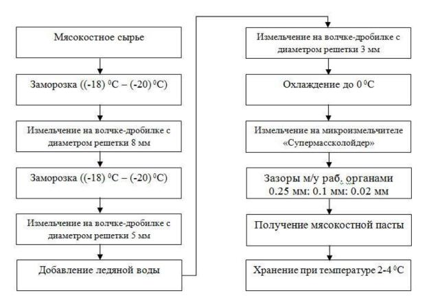
Рисунок 1 - Схема измельчения мясокостного сырья
