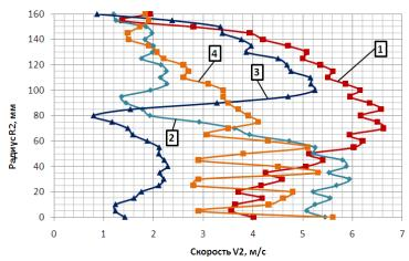
Рисунок 5 — Профили поля скоростей перед фильтрующим элементом (сечение 2-2) для варианта с: 1 — диффузором без направляющих; 2 — диффузором с концентрическими направляющими; 3 — неполной перфорированной пластиной в диффузоре; 4 — решеткой за диффузором
