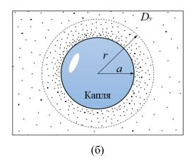
Рисунок 1 – Описание процесса: а – падение капли; б – процесс охлаждения капли воды при давлении ниже тройной точки
