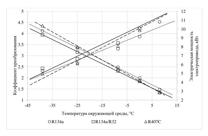
Рисунок 4 — Изменение коэффициента преобразования и электрической мощности электропривода от температуры окружающей среды для ТН без регенеративного теплообменника
