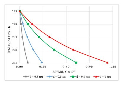
Рисунок 2 — Время охлаждения капли в вакууме. Исходные данные:  $T_a = 293$  K;  $P_{\infty} = 400$  Па; u = 1,2 м/с.
