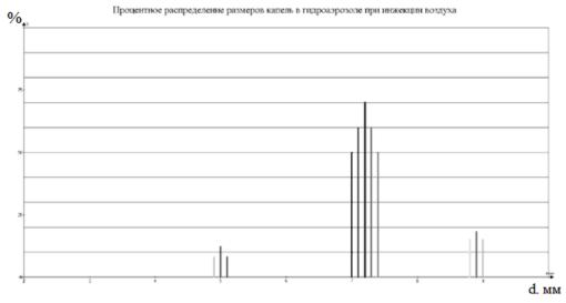
Рисунок 2 — Процентное распределение размеров капель в гидроаэрозоле при инжекции воздуха
