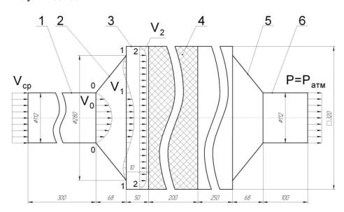
Рисунок 1 — Расчётная схема проточной части воздушного фильтра с коротким диффузором: 1 — входной воздуховод; 2 — короткий диффузор; 3 — корпус; 4 — фильтрующий элемент; 5 — конфузор; 6 — выходной воздуховод
