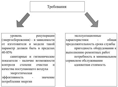
Рисунок 1 – Требования, предъявляемые к рекуператорам теплоты
