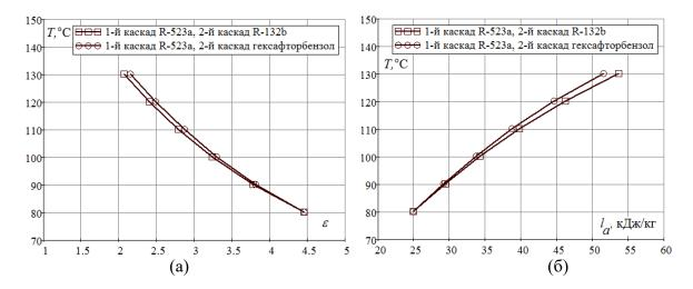
Рисунок 4 — Зависимость температуры насыщенного пара фреона для каскадного цикла холодильной машины от: а — холодильного коэффииента, б — работы сжатия
