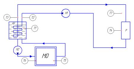
Рисунок 1 – Гидравлическая схема молокоохладительной установки:
