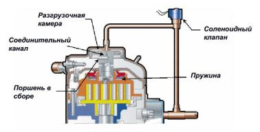
Рисунок 4 – Механизм регулирования
