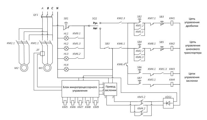
Рисунок 5 – Принципиальная электрическая схема соединений электропривода дробилки
