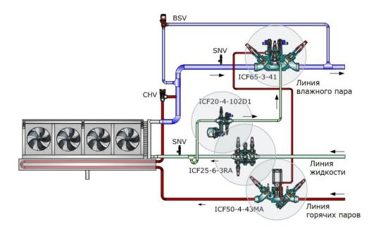
Рисунок 2 — Применение станции ICF 15 с модулем ICFD 20 в системе с насосной подачей и оттаиванием испарителя горячими парами
