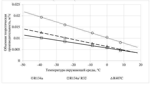
Рисунок 3 — Зависимость объёмной производительности компрессора от температуры окружающей среды для теплового насоса без регенеративного теплообменника
