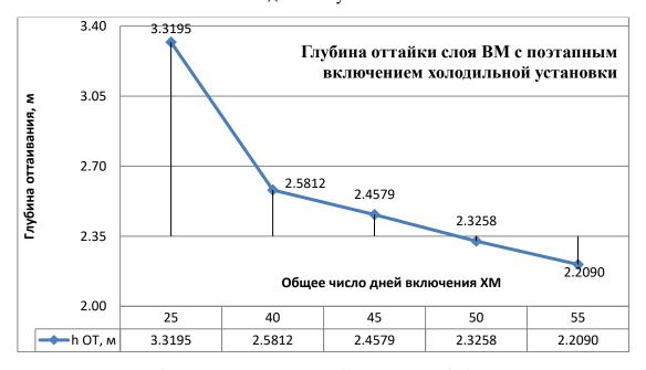
Рисунок 3 — Глубина оттаивания грунта (начало сентября) с использованием СОУ холодильной установки при поэтапном включении
