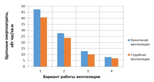
Рисунок 4 — График удельных среднесуточных энергопотреблений канальной и струйной вентиляции, работающей в режимах, перечисленных в таблице 2
