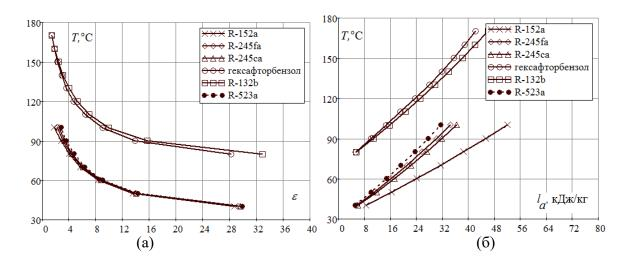
Рисунок 2 — Зависимость температуры насыщенного пара фреона при одноступенчатом сжатии от: а — холодильного коэффииента, б — работы сжатия
