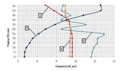
Рисунок 3 — Профили поля скоростей во входном сечении короткого диффузора (сечение 0-0) для варианта с: 1 — диффузором без направляющих; 2 — диффузором с концентрическими направляющими; 3 — неполной перфорированной пластиной в диффузоре; 4 — решеткой за диффузором
