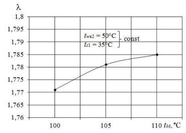
Рисунок 3 – График зависимости коэффициента трансформации от температуры греющего источника
