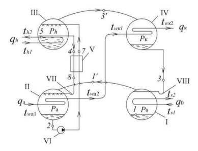
Рисунок 1 — Схема одноступенчатого абсорбционного понижающего термотрансформатора I — испаритель, II — абсорбер, III — генератор, IV — конденсатор, V — теплообменник растворов, VI — насос, VII, VIII — гидравлический затвор
