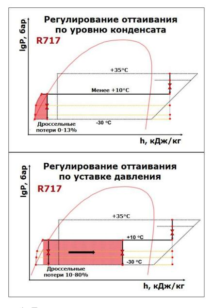
Рисунок 4 — Представление регулирования оттаивания горячими парами на энтальпийных диаграммах
