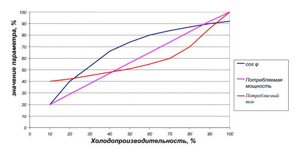
Рисунок 7 — Технические характеристики: взаимосвязь между потребляемой мощностью, потребляемым током и соѕф и нагрузки на компрессор
