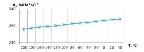
Рисунок 5 — Влияние низких температур на трещиностойкость исследованной стали 12X18H10T
