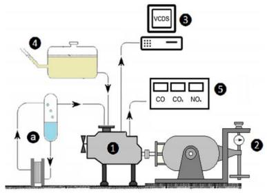
Рисунок 2 - Принципиальная схема испытательного стенда
