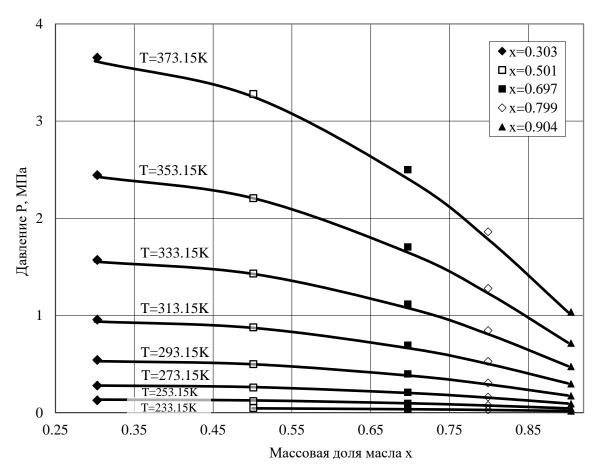
Рисунок 2 – Диаграмма Р-х смеси смазочного масла ISO 22 и хладона R134a
