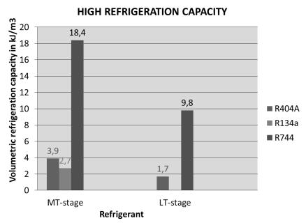
Рисунок 1 — Сравнительная холодопроизводительность CO<sub>2</sub> систем и систем на традиционных холодильных агентах
