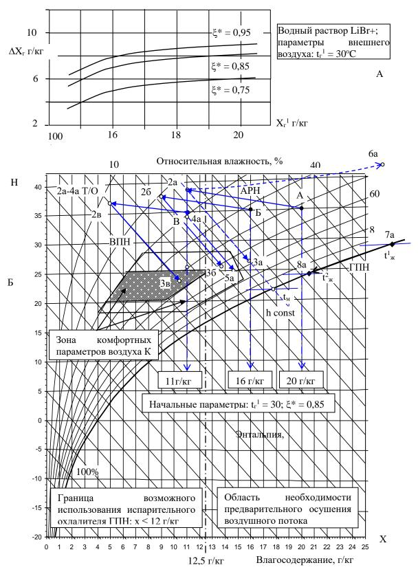
Рисунок 2 — Зависимость изменения влагосодержания воздуха в абсорбционной колонне от приведенной концентрации раствора и влагосодержания внешнего воздуха (A). Принципиальные возможности солнечных систем на основе открытого абсорбционного цикла при использовании их для кондиционирования воздуха (Б).
