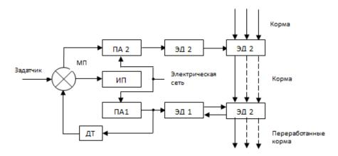
Рисунок 1 — Функциональная схема системы регулирования МК — микроконтроллер; ИП — индикационный прибор; ДТ — датчик тока; ПА1, ПА2 — пусковая аппаратура; ЭД1 — электродвигатель рабочегооргана; ЭД2 — электродвигатель задвижки; РО — рабочий орган; ЗБ —задвижка бункера
