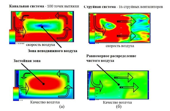
Рисунок 3 – Результаты CFD моделирования воздухораспределения при работе канальной и струйной вентиляции: а – канальная вентиляция, б – струйная вентиляция
