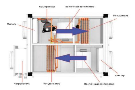
Рисунок 1 – Элементы вентиляционной системы использующей тепловой насос в качестве первичного теплоутилизатора
