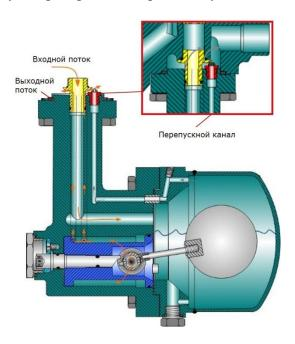
Рисунок 3 – Устройство поплавкового модуля ICFD 20
