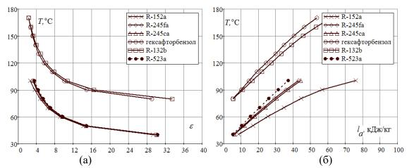
Рисунок 3 — Зависимость температуры насыщенного пара фреона при двухступенчатом сжатии с полным промежуточным охлаждением от: а — холодильного коэффииента, б — работы сжатия
