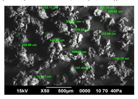
Рисунок 2 – Размеры костных частиц мясокостной пасты
