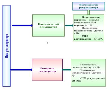
Рисунок 2 — Возможность использования различных видов рекуператоров в системах кондиционирования воздуха
