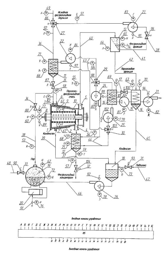
Рисунок 1 — Схема управления процессом выпаривания влаги из фосфолипидной эмульсии; обозначения позиций приведены в тексте
