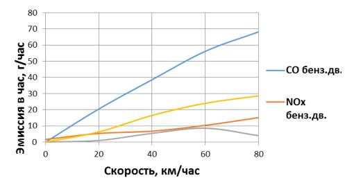
Рисунок 1 – Графики зависимостей скорости эмиссии CO и NOx от скорости движения легковых автомобилей с бензиновым и дизельным двигателем
