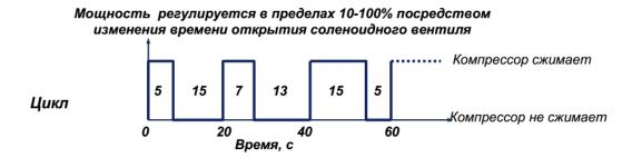
Рисунок 6 – Цикл регулирования мощности
