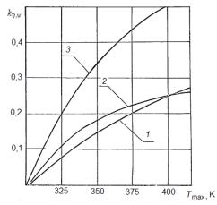
Рисунок 3 — Зависимость коэффициента использования теплоты от максимальной температуры цикла
