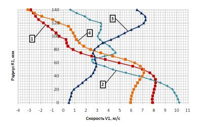
Рисунок 4 — Профили поля скоростей в выходном сечении короткого диффузора (сечение 1-1) для варианта с: 1 — диффузором без направляющих; 2 — диффузором с концентрическими направляющими; 3 — неполной перфорированной пластиной в диффузоре; 4 — решеткой за диффузором
