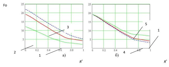
Рисунок 3 – Продолжительность замораживания системы в зависимости от относительной концентрации фракции В: а) – влияние начальной неизотермичности системы; б) – влияние теплофизической неоднородности системы.
