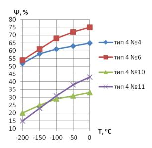
Рисунок 3 — Влияние низких температур и наличия концентраторов напряжения на величину относительного сужения образцов из стали 12X18H10T
