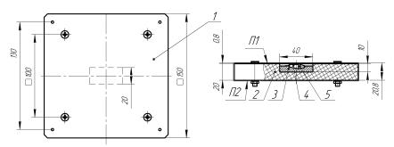
Рисунок 1 — Схема экспериментального образца: 1 — излучающая пластина; 2 — теплоизоляция; 3 — теплоизоляционный вкладыш; 4 — хомут; 5 — датчик температуры
