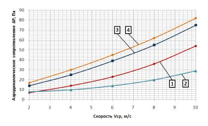
Рисунок 6 — Зависимость аэродинамического сопротивления фильтра с коротким диффузором от средней скорости потока для варианта с: 1 — диффузором без направляющих; 2 — диффузором с концентрическими направляющими; 3 — неполной перфорированной пластиной в диффузоре;
