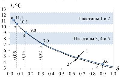
Рисунок 4 — Теоретические значения температуры в зависимости от коэффициента относительной излучательной способности поверхности при параметрах атмосферного воздуха во время 1-ой серии опытов:  $t_{\rm B} = 15,5$ °C;  $\varphi_{\rm B} = 48\%$ : 1 — термометр под пластиной; 2 — излучающая поверхность
