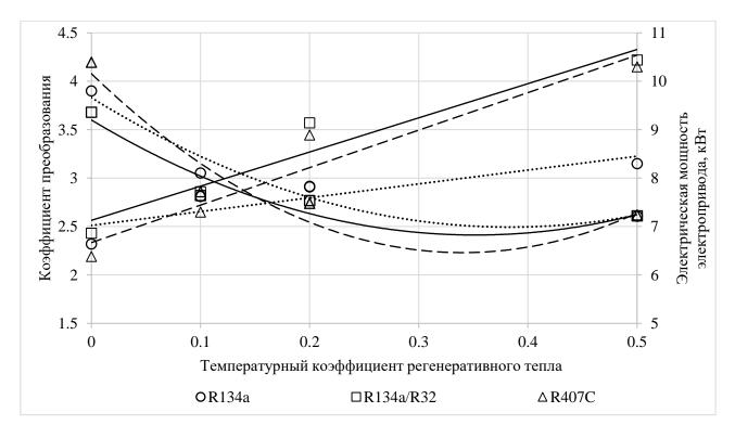
Рисунок 5 — Изменение коэффициента преобразования иэлектрической мощности электропривода от температурного коэффициента регенеративного тепла для ТН с регенеративным теплообменником
