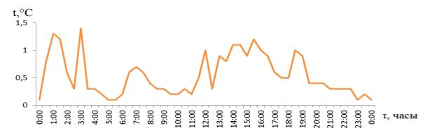
Рисунок 2 — Изменение температуры хладоностиеля, выходящего из аккумулятора холода в технологический цех предприятия и на приёмку сырья.
