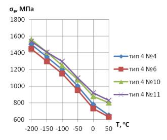
Рисунок 2 — Влияние низких температур и наличия концентраторов напряжения на величину значений временного сопротивления образцов из стали 12X18H10T
