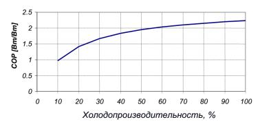
Рисунок 8 – Зависимость холодильного коэффициента от холодопроизводительности
