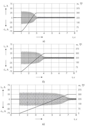
Рисунок 2 — Осциллограммы мгновенных значений тока и скорости двигателя при пуске а) при пустом барабане дробилки; б) при наличии остатка
