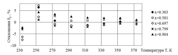
Рисунок 4 — Отклонения рассчитанных по уравнению (1) значений от экспериментальных данных по давлению кипения смеси смазочного масла ISO 22 и хладона R134a
