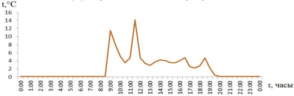
Рисунок 1 — Изменение температуры хладоностиеля, поступающего в аккумулятор холода с приёмки молока в течение суток
