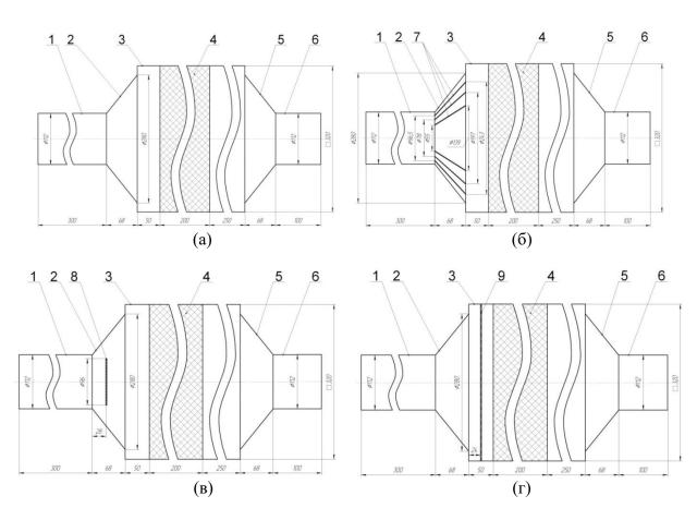
Рисунок 2 — Расчётные схемы проточной части воздушного фильтра с коротким диффузором:
