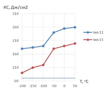
Рисунок – 4 Влияние низких температур и вида концентратора напряжения на значения ударной вязкости стали 12X18H10T
