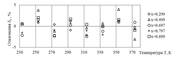
Рисунок 5 – Отклонения рассчитанных по уравнению (2) значений от экспериментальных данных по вязкости смеси смазочного масла ISO 22 и хладона R134a
