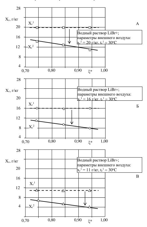
Рисунок 1 - Зависимость изменения влагосодержания воздуха в абсорбционной колонне от приведенной концентрации раствора и влагосодержания внешнего воздуха.
