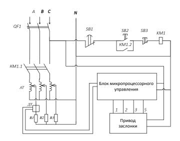
Рисунок 3 — Принципиальная электрическая схема лабораторного стенда
