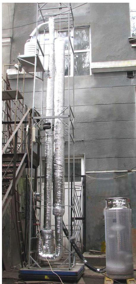
Рисунок 1 – Схема (а) и внешний вид (б) установки для исследования расходных характеристик парлифтного нагнетателя: 1 – питающий сосуд диаметром 80 мм; 2 – подъемный участок трубы; 3 – вентиль, соединяющий сосуды; 4 – источник внешнего тепла (ТЭНы); 5 – сепаратор; 6 – сосуд Дьюара; 7 – электронные весы (малые); 8 – подвески; 9 – низкотемпературная теплоизоляция; 10 – электронные весы (большие); 11 – источник рабочего тела (криоцилиндр)
