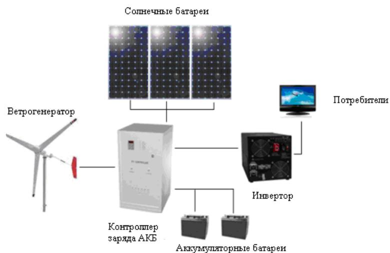
Рисунок 3 - Типовая схема гибридной автономной системы солнце-ветер.
