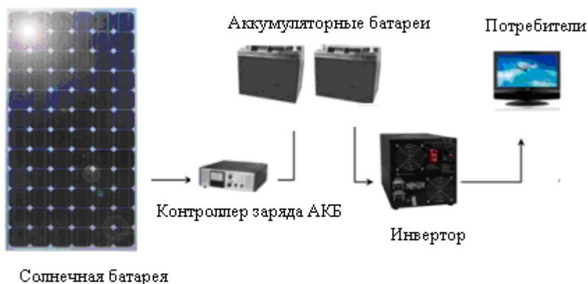
Рисунок 1 - Типовая схема автономного обеспечения объекта солнечными батареями (с аккумуляторами)
