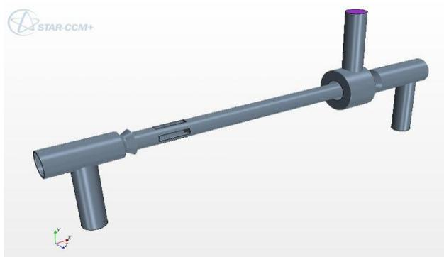
Рисунок 1 – Геометрия исследуемой вихревой трубы
