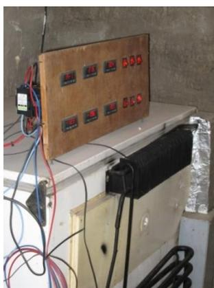
Рисунок 1 – Внешний вид лабораторного стенда на базе абсорбционного холодильника типа «Ларь» вместимостью охлаждаемого объёма 100 дм<sup>3</sup>
