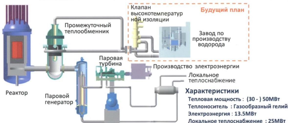
Рисунок 1 – Принципиальная схема АЭС с реактором КНТР
