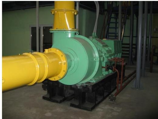
Рисунок 2 – Экспериментальный стенд для испытаний модельных рабочих колес и ступеней
