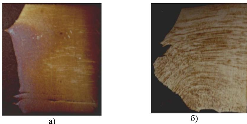
Рисунок 3 – Влияние химического состава на деформационные мартенситные превращения сталей плавки 1 (а) и б (б) после испытаний на статический изгиб при 20 К: синим цветом окрашена  $\alpha$ -фаза
