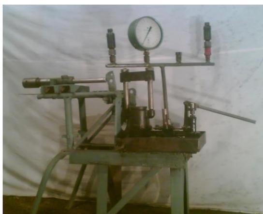
Рисунок 2 – Прибор для определения изменения относительного объёма масляного материала от усилий сжатия семян
