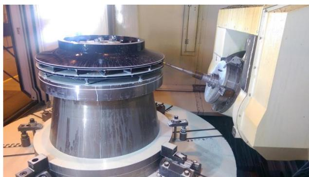
Рисунок 7 – Изготовление цельнофрезерованного осерадиального рабочего колеса с 3D лопатками на пятикоординатном станке.
