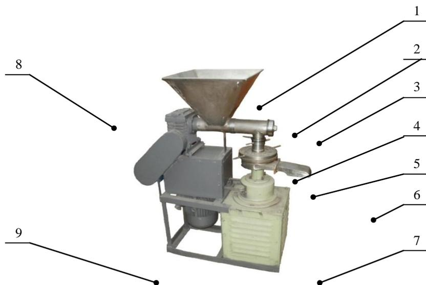
Рисунок 1 – Установка для тонкого измельчения мясного и мясокостного фарша со шнековым питателем
