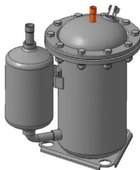
Рисунок 1. Модель макета ротационной компрессорной установки
