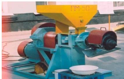
Рисунок 3 – Экструзионный маслоотжимной пресс ПМ – 100.
