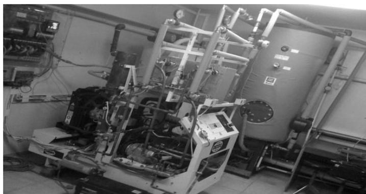
Рисунок 1 - Лабораторный стенд тригенерационной установки.
