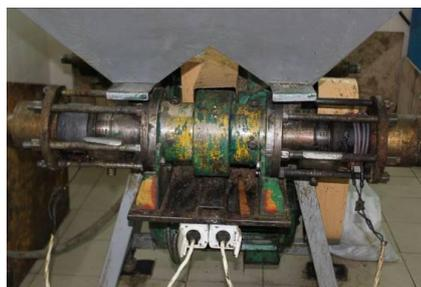
Рисунок 2. Маслоотжимной пресс Андромеда Расма 150У (Болгария), с двойной прессующей головкой, на наружном корпусе прессующего тракта которого установлены нагревательные элементы.
