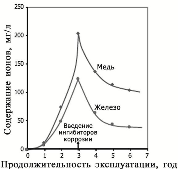
Рисунок 2 - Изменение концентрации продуктов коррозии в составе хладоносителя после введения ингибитора КПП-ПК.
