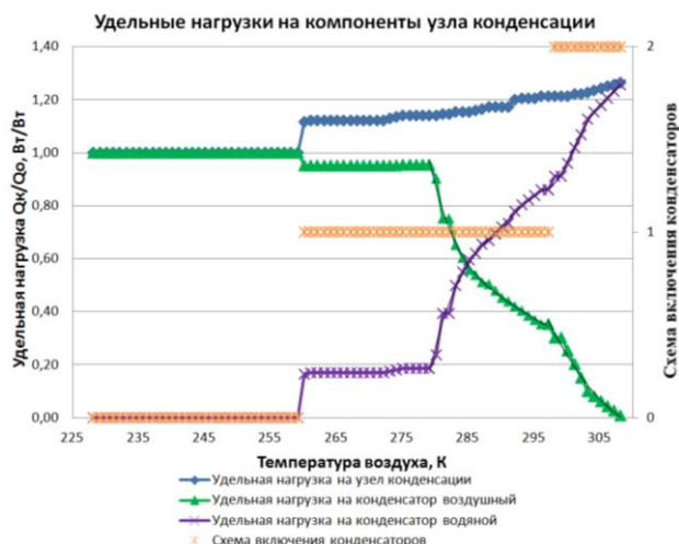
Рисунок 3 – Удельные нагрузки на конденсаторы при изменении распределения нагрузок между конденсаторами и изменении схемы включения конденсаторов: 0 – естественная циркуляция хладагента; 1 – последовательное включение конденсатора водяного, затем воздушного охлаждения; 2 – последовательное включение конденсатора воздушного, затем водяного охлаждения
