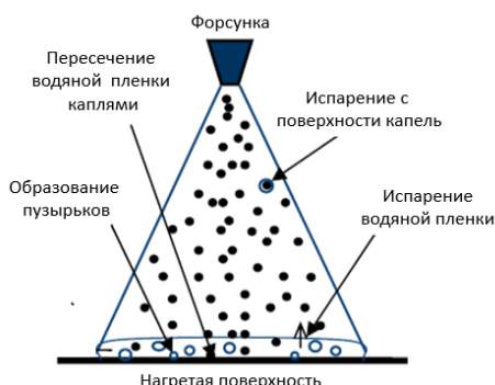
Рисунок 1 – Механизмы теплообмена вакуумного испарения
