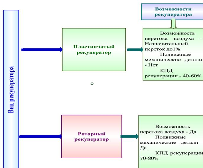
Рисунок 2 – Возможность использования различных видов рекуператоров в системах кондиционирования воздуха
