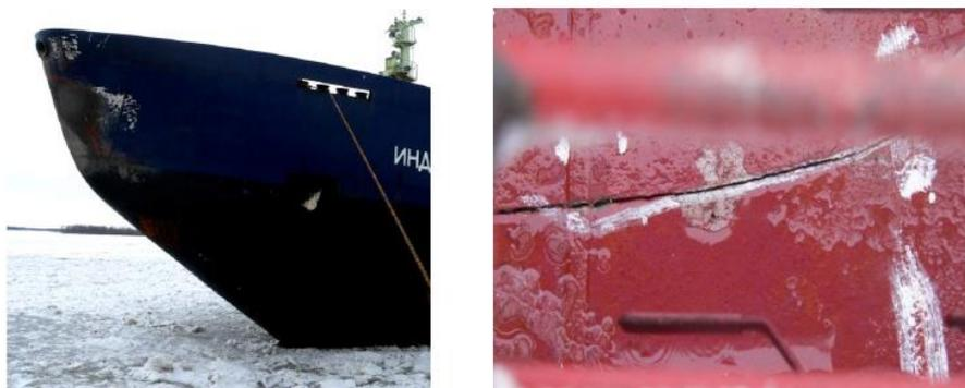
Рисунок 1 – Разрушение детали трубопровода от поперечной трещины в зоне термического влияния сварного шва на судне при эксплуатации при низких температурах
