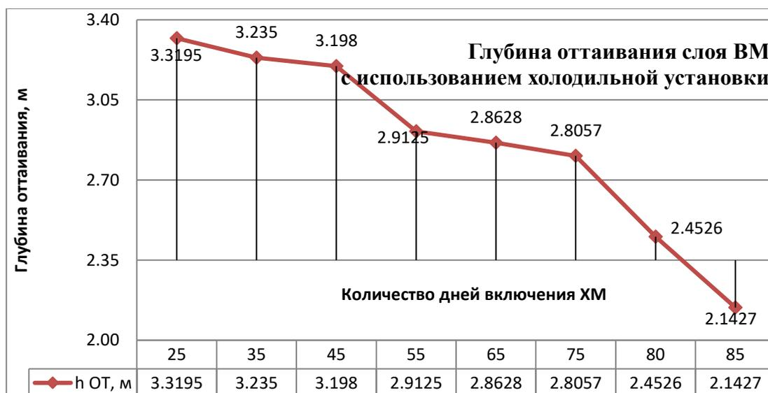
Рисунок 2 – Глубина оттаивания грунта (начало сентября) с использованием СОУ холодильной установки
