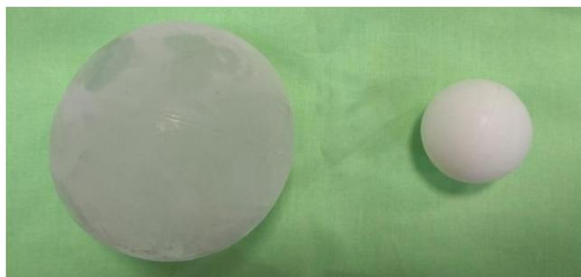
Рисунок 3 – Герметичные ёмкости, заполненные эвтектическим раствором различного диаметра 75 и 40 мм
