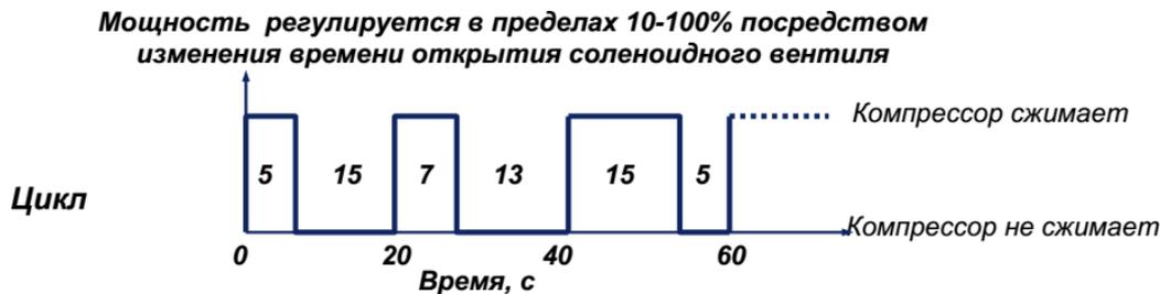
Рисунок 6 – Цикл регулирования мощности
