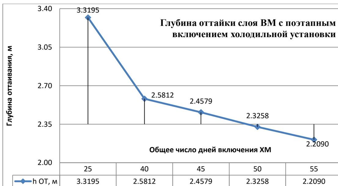
Рисунок 3 – Глубина оттаивания грунта (начало сентября) с использованием СОУ холодильной установки при поэтапном включении
