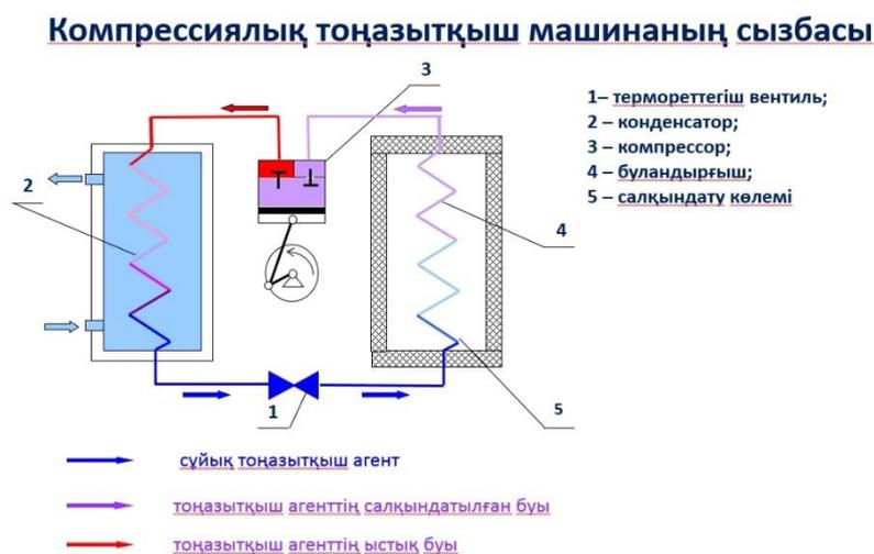
Рисунок 1 – Схема компрессорной холодильной машины
